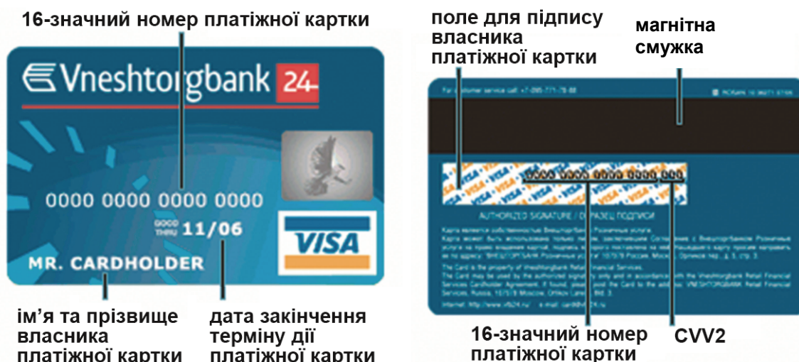
Рис. 6.1. Будова магнітної пластикової картки
